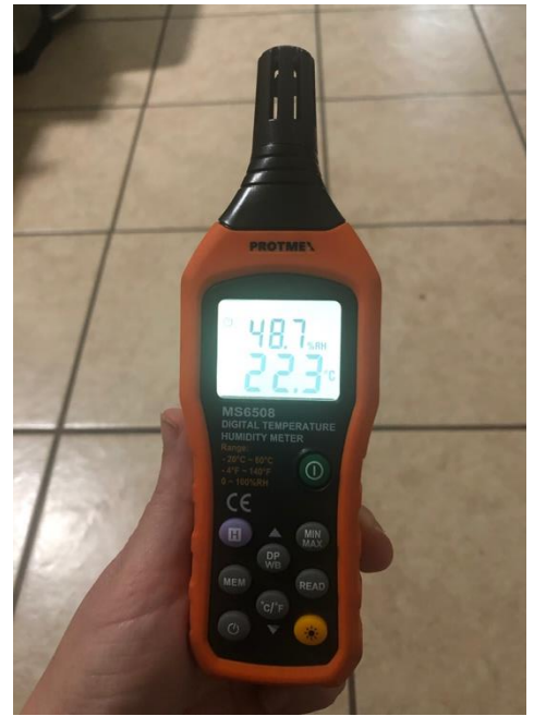
Figura 4: Utilice un detector de humedad para medir y controlar la humedad. Imagen: BASTA
